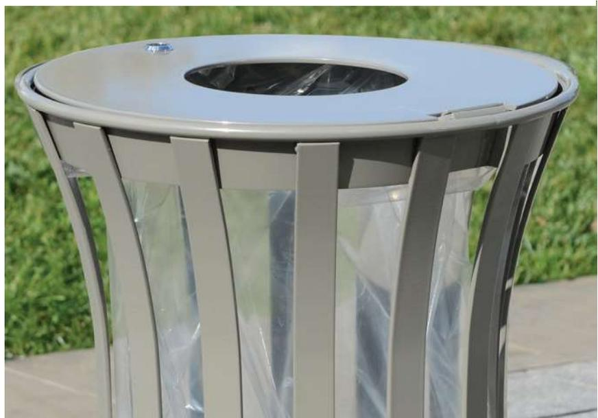
Corbeille constituée d'un couvercle tôle acier ép 5 mm monté sur charnière renforcée. Corps en plat acier de 35 x 5 mm, cerclage supérieur en rond  $\varnothing$  12 mm
