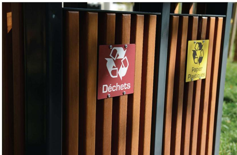
Corbeille constitu e d'un ch ssis en tube acier 80 x 40 mm avec des lattes de bois exotique 30 x 35 mm. 2 couvercles en t le acier  p. 5 mm mont  sur charni res verrouill es par serrures quart de tour.
