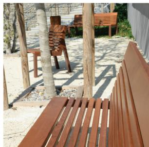
Banquette constituée d'un piètement en tube acier 80 x 40 mm et d'une assise en bois exotique. Les planches de bois section 120 x 35 et 38 X 35 mm sont fixées par visserie inox. Ce produit est à fixer au sol conformément à la norme NF P99-610 catégorie "S", par tiges de scellement ø 12 non fournies. Ancrage par 4 points entraxes 1760 x 505 mm.
