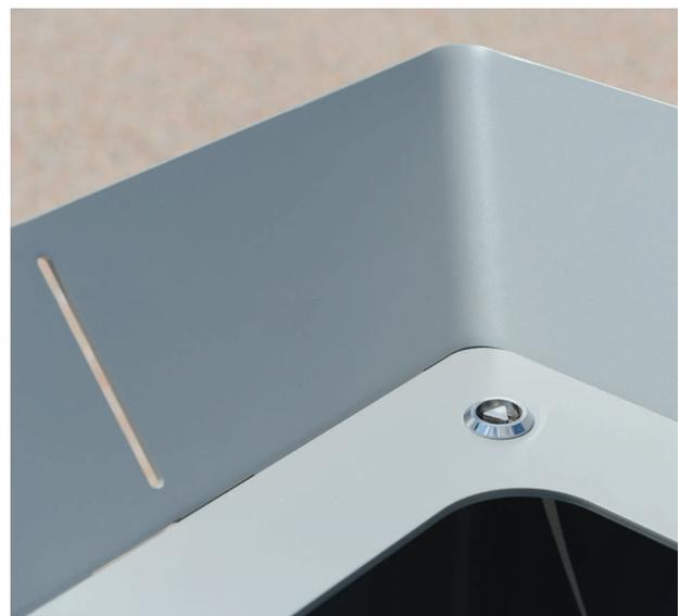
Corbeille constituée d'un corps en tôle acier ép. 2 mm et d'un couvercle avec collerette en tôle acier ép. 4 mm. Le couvercle est monté sur charnières et verrouillé par serrure quart de tour. Bac intérieur métallique de 75 litres avec anse. Ancrage par 4 points entraxes 140 mm.
