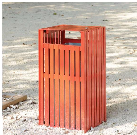
Corbeille constituée d'un Corps en plat de 35 x 5 et profil "T" de 35 x 35 mm et de 3 couvercles en tôle acier ép 5 mm montés sur charnières et verrouillés par serrures quart de tour.
